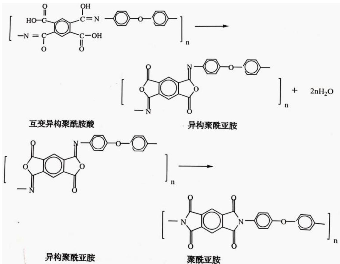
根据查阅相关资料，异构聚酰亚胺在加热条件下很容易异构化为聚酰亚胺，本评价考虑99%的异构聚酰亚胺在加热情况下转化为聚酰亚胺，剩余的极少量未反应的PMDA和ODA以及未转化的聚酰胺酸、异构聚酰胺酸、异构聚酰亚胺进入产品。
