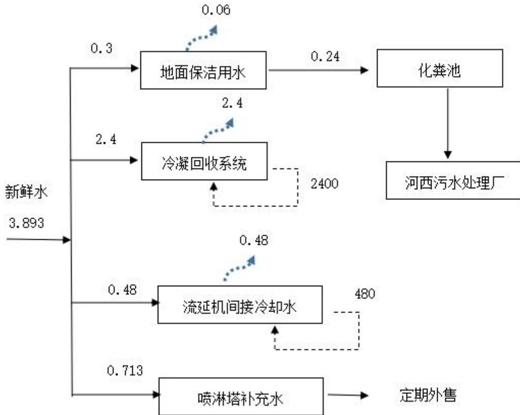
图 3.2.7-1 项目水平衡图（单位：t/d）
