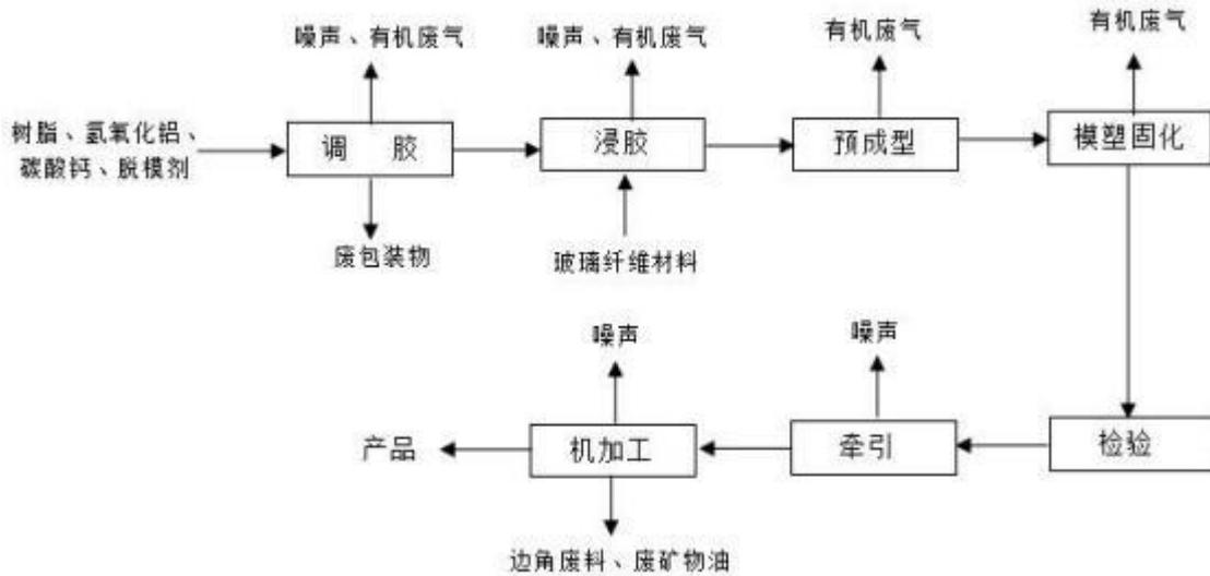
图 3.1.6-4 引拔系列产品生产工艺流程及产排污节点图
