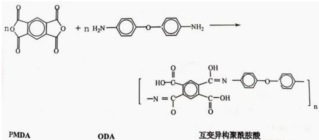
(2) 亚胺化反应：亚胺化反应以聚酰胺酸计，反应转化率为 99.3%，互变异构聚酰胺酸反应转化率为 99.1%，异构聚酰亚胺在加热条件下转为聚酰亚胺的转化率为 99%。
