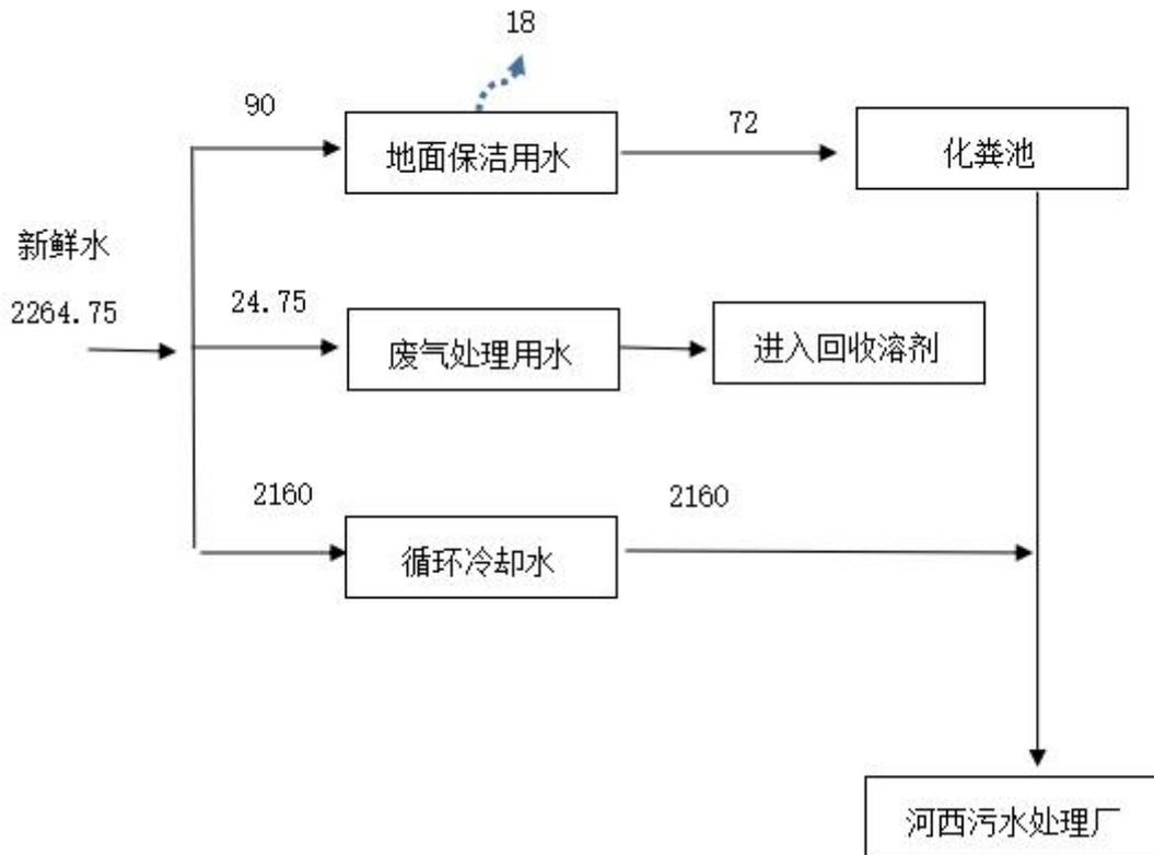
图 3.3.2-1 项目水平衡图 (单位: t/a)
