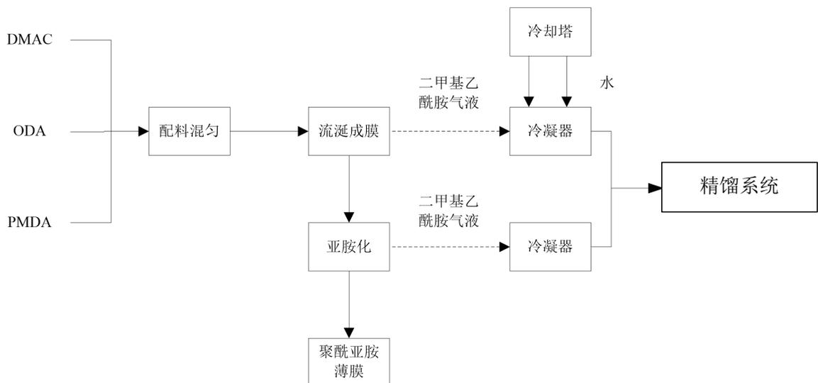
图 3.3.1-3 溶剂回收工艺流程图
